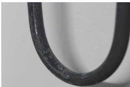
写真3: 付着物のあるヒーター
