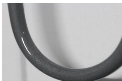
写真4: 再生焼成後のヒーター
