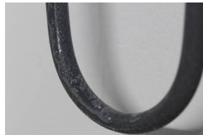
写真 4: 付着物のあるヒーター
