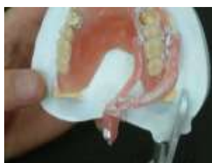
⑥再射出成型を行い、プラスチックから割り出して義歯を取り出します。
