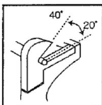
側方運動時、顎路角プレートの下辺を滑走させると20°の傾斜角で運動し、上辺を滑走させると40°の傾斜角で運動します。
