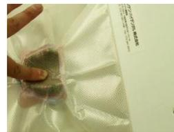
⑩熱シーラーされたSESフィルムは開封せずに、そのまま紫外線光重合器で4分間照射し重合させます。
