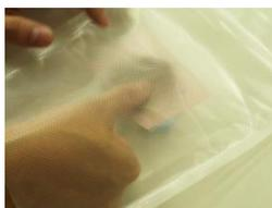
⑧SESフィルムの切り口部分をSESハキュームの脱気溝(スポンジハットの中)に乗せ、カバーを閉めてロックします。
