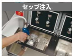
フラスコ注入口からセップガンで分離材を注入。
