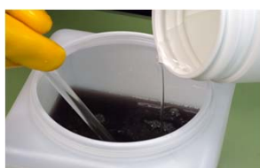
攪拌しながら「B沈殿剤」を 少しずつ加える
