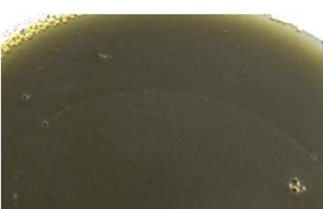
更に「B沈殿剤」を加えていくと 廃液が濁り始め、細かい沈殿 が大量に発生し、とろみが出る。 ここで「B沈殿剤」の投入を止める。
