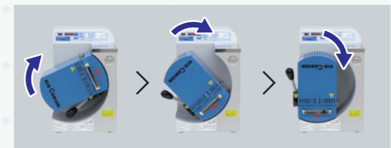
鑄造ボタンを押すと、自動で回転し真空加圧鋳造を行います。 【3機種共通】
