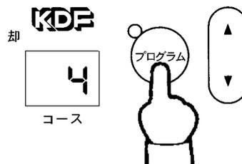
**3** スタート温度ランプが点灯する。表示が **1250** になるように **▼**、**▲** ボタンで設定します。正しく設定できれば **OK** ボタンを押します。
